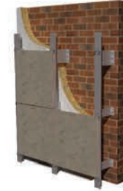
HBФ VF110 керамогранитные панели на кляймерах. Стр. 43.
